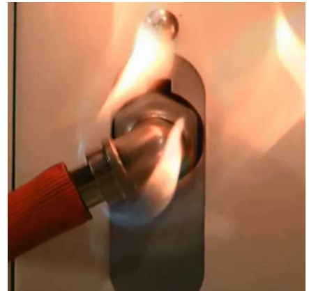
（写真）指定されたガス接続具を使用せず、ガス用ゴム管を使用し、ガスが漏れて引火（別紙3）
