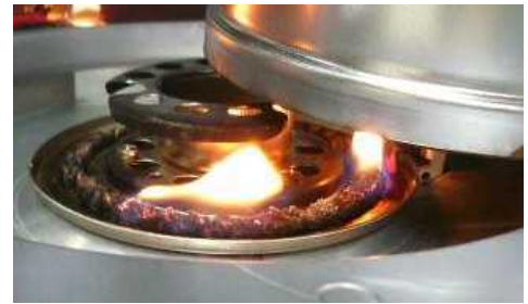
(図) 芯が下がらず、消火不良となった芯式石油ストーブ
